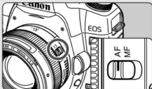
**Set the lens focus mode switch to <AF>.** (p.31)
